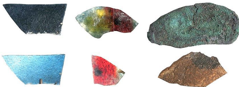
Links: Blaufarbenes Flachglas, fotografiert in natura (korrodiert) und im Gegenlicht. Mitte: Teils rot durchfärbtes Glasfragment, Teilstück unten im Gegenlicht fotografiert. Rechts: Oben flaches Bruchstück aus Kupfer, unten Rest aus rotbrauner Glasmasse.
