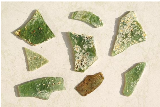
Scherben von grünem Flachglas, vmtl. Holzasche-Kalk-Glas.
