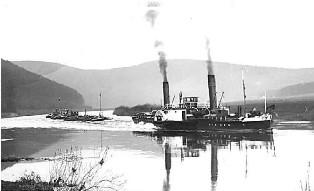
Oben: Schleppdampfer SIEGFRIED mit Schleppzug während der Bergfahrt unterhalb von Waldesruh. Mit seiner 515-PS-Dampfmaschine und 2 Kesseln war SIEGFRIED einer der stärksten Schlepper und fuhr von Bremen meist mit 5 Kähnen im Schlepp. Auf der Oberweser kam er nur bei hohem Wasserstand zum Einsatz.
