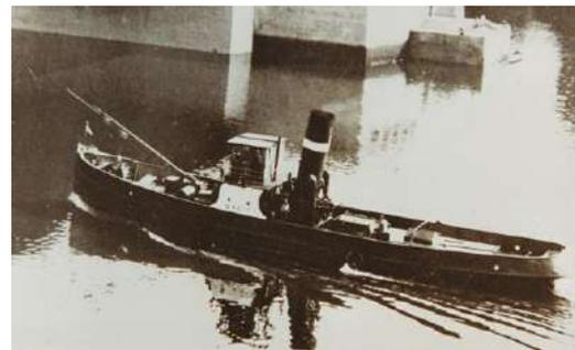
Links: Der kleine Schlepper BOMBE (Foto), 180 PS, Schraubenantrieb, sowie später die Schlepper ALLER und SPERBER befanden sich 1955 bis 1965 im Besitz von Heinrich Rossel. Die Dampfer dienten vorwiegend als Bugsierer und Hafenschlepper in den Bremer Häfen, bei Bedarf auch auf der Unterweser bis Brake und der Hunte bis Oldenburg.
