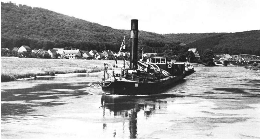
Oben: Güterdampfer VLOTHO mit angehängtem Schleppkahn, oberhalb von Gieselwerder. Er hatte eine Dampfmaschine von 170 PS und einen Heckrad-Schauflertrieb. 1938 gehörten aus Gieselwerder zur Besatzung: Matrose Wilhelm Weskamp und Schiffsjunge Karl Gerke.
