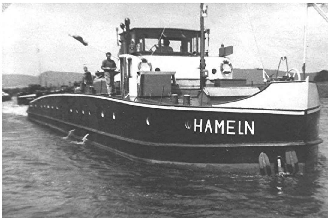
Oben: Motorschlepper HAMELN, eigenwillig geformtes Deck, ausgerüstet mit 3 Dieselmotoren mit Gesamtleistung von 540 PS. Geringer Tiefgang, besonders geeignet für die Oberweser.
